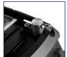
Υποδοχή για σύνδεση με εργαλεία αέρος
